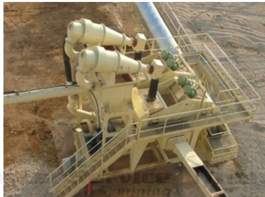
Estructuras base para hydrociclones
