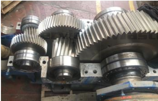
Reductores de potencia
